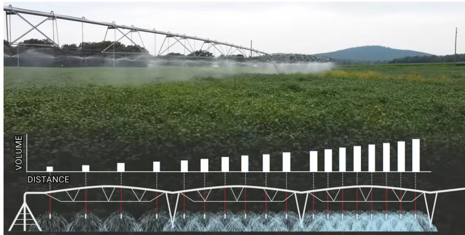
**FIGURE 6.11** – Régulation de débits des arroseurs d'un pivot en fonction de l'éloignement par rapport à l'axe de rotation
