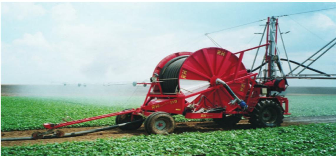
**FIGURE 6.13** – Irrigation par rallonge à tuyau souple
