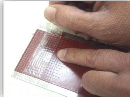
Figure III. 30 : Résultat du test d'adhérence.
