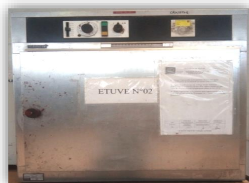
Figure III. 11 : Etuveuse de séchage N°2.
