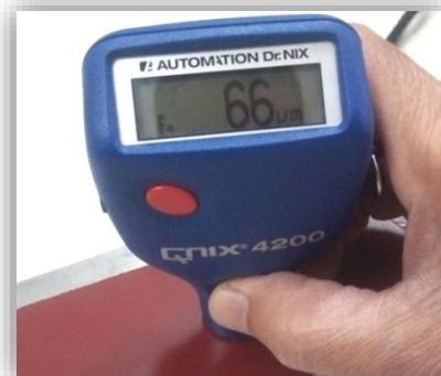
Figure III. 28 : Résultat de la mesure de l'épaisseur.
