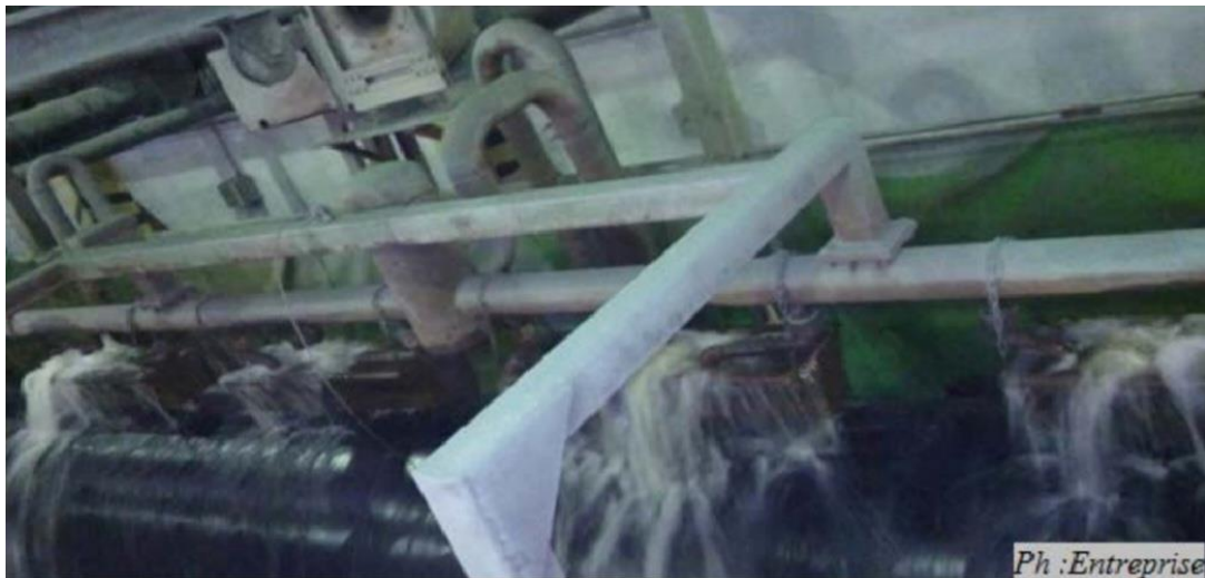
Figure III. 3: Refroidissement laminaire des tubes.
