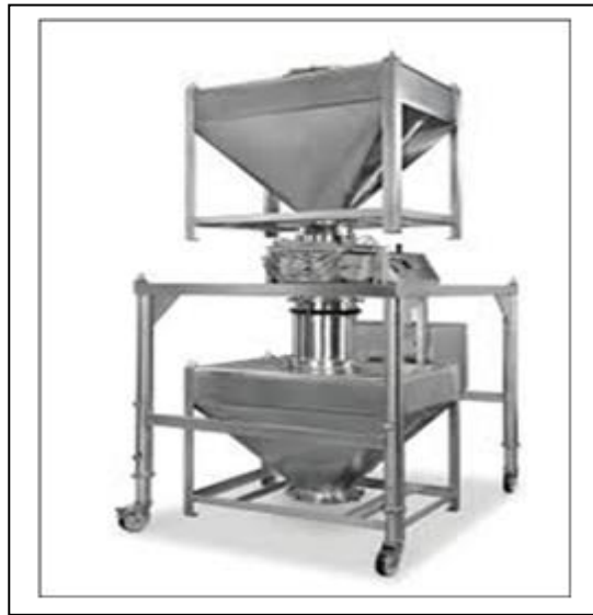
Figure III.5 : Appareil pour le calibrage « FREWITT ».
