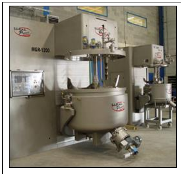
Figure III.3: mélangeur granulateur de type « COLETTE ».
