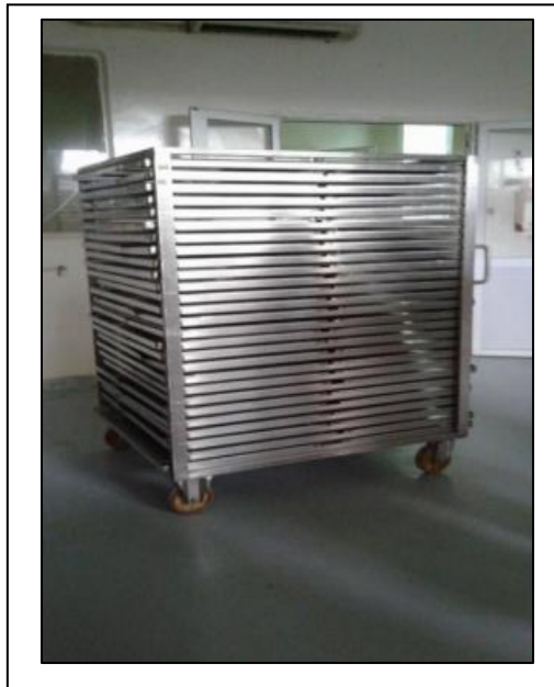
Figure III.4 : Le séchage des poudres de PARALGAN effectué sur un lit en inox.
