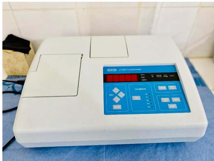
Figure III. 4: Turbidimètre optique et électronique utilisé (HACH modèle 2100N)
