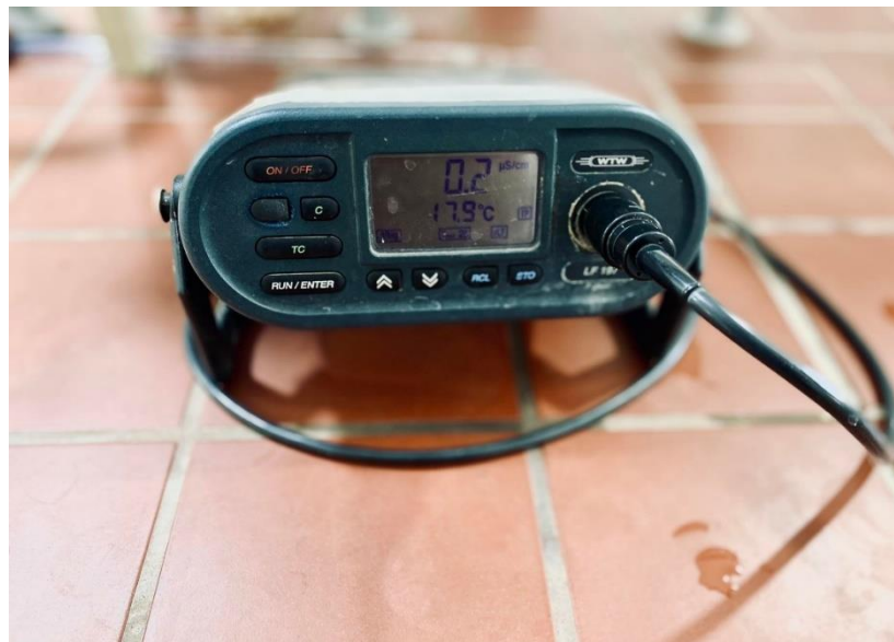
Figure III. 3: Conductimètre utilisé de marque WTW inoLab 720
