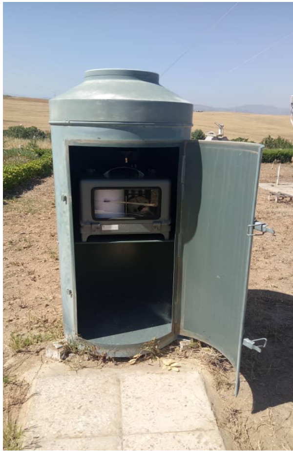
Figure 3 : Vue générale d'un pluviographe.
