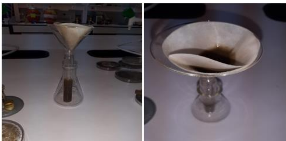
Figure 8 : Système de filtration adopté durant l'expérimentation pour la préparation des suspensions de spores des deux souches fongiques.
