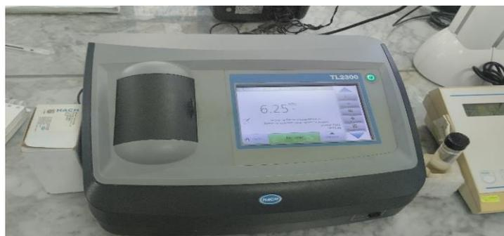
**Figure N°15: Turbidimètre « TL 2300 ».**
