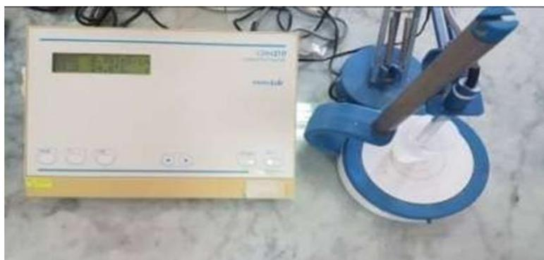
**Figure N°16:** Conductimètre.
