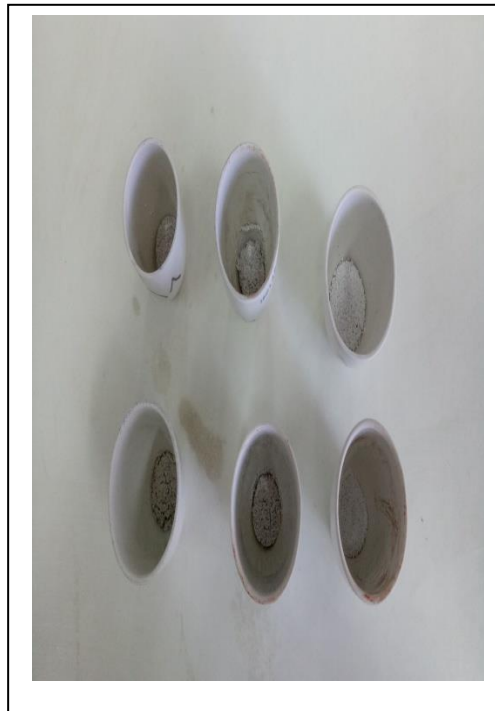
Figure 9: Creusé contenant un résidu blanchâtre après incinération.
