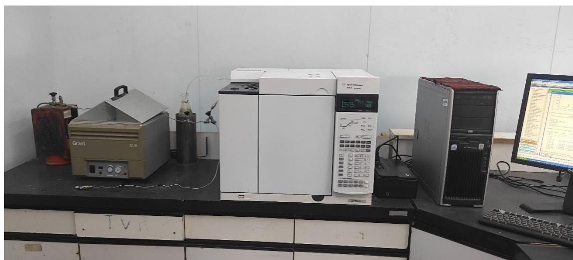
Figure IV- 5: Représente l'appareil de chromatographie
