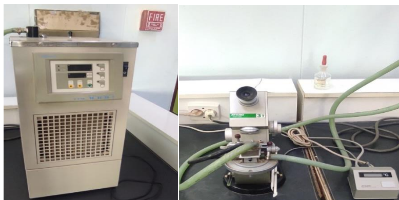
Figure IV- 11: Représente l'appareil de réfractomètre
