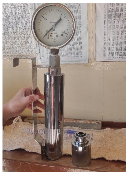
Figure IV- 7: manomètre et bombe de TVR
