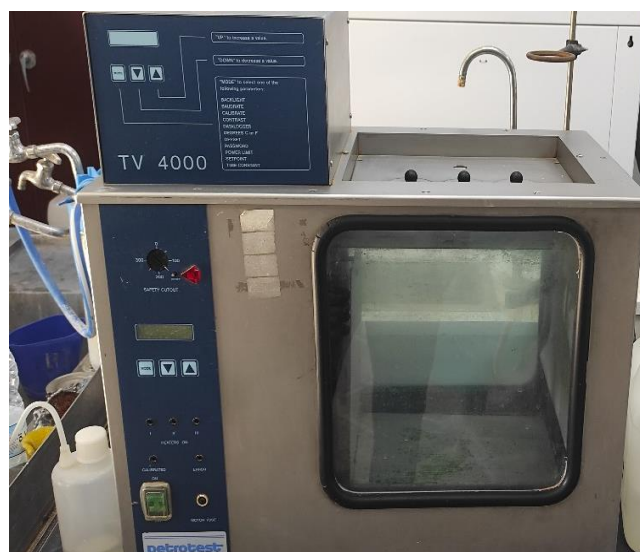
Figure IV- 13: Pompe à vide et bain de viscosité
