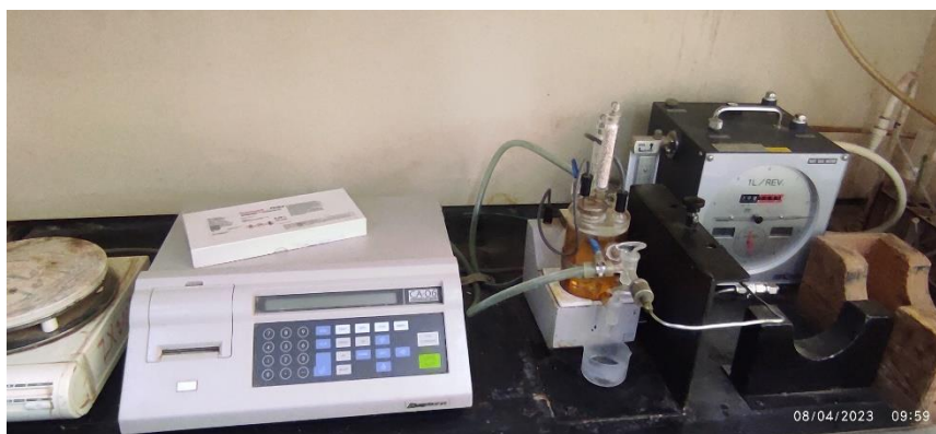
Figure IV- 4: représente l'appareille de Karl Fisher
