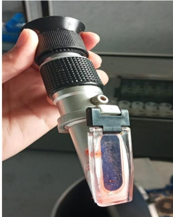
**Figure III.8:** Refractomètre portatif.
