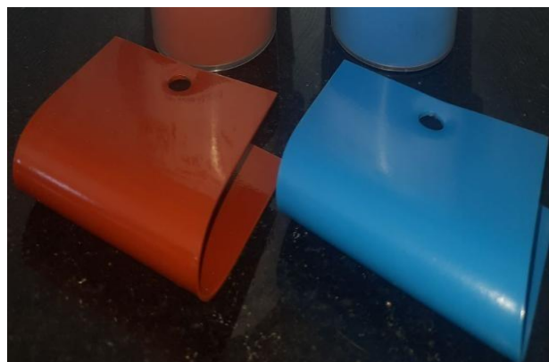
Figure II.10. Résultat de pliage conique.
