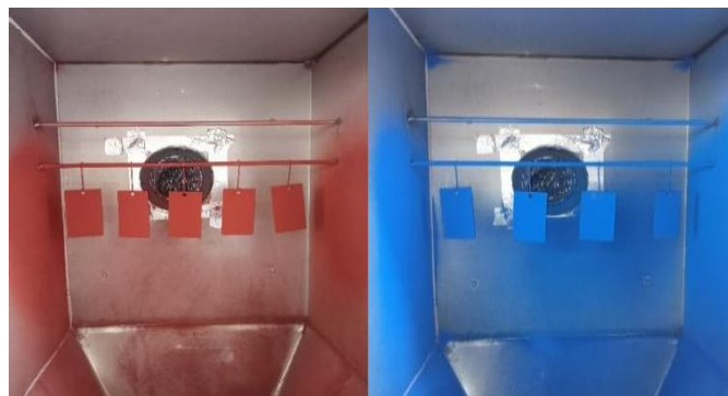
Figure I.11. Cabinet de poudrage.
