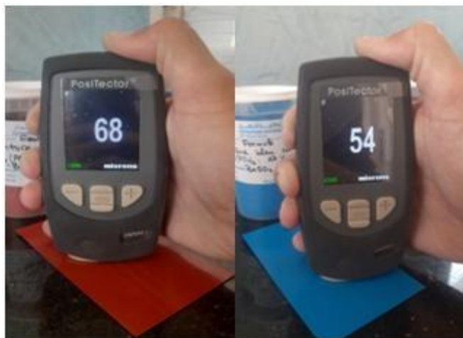
Figure II.6. Résultat de test d'épaisseur pour les deux peintures Bleu ciel et Rouge brique.
