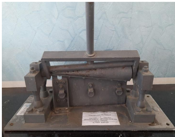
Figure II.9. Appareil de pliage conique.
