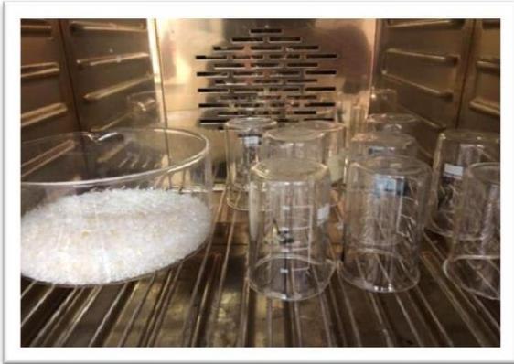
**Figure n°03:** Séchage des béchers dans l'étuve (Originale).
