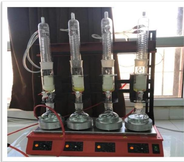
Figure n°09: Appareil de type Soxhlet (Originale).
