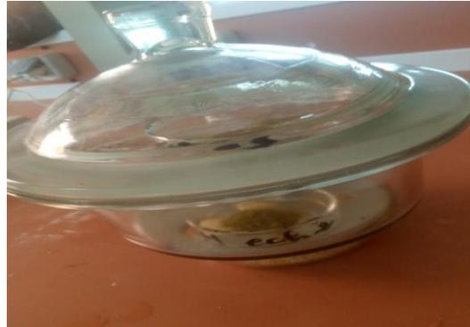
**Figure03** : détermination de la teneur en eau
