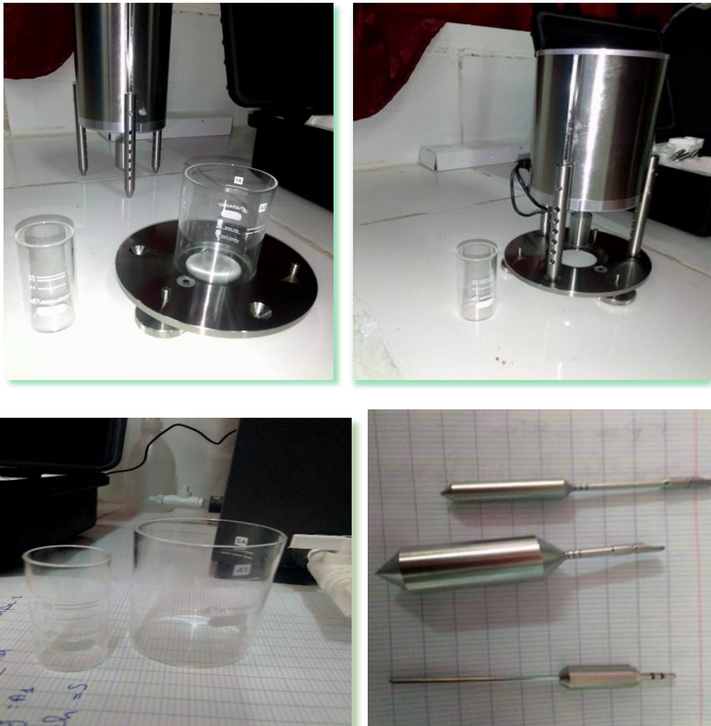
Figure 20: Présentation du matériel utilisé viscosimètre rotatif numérique (ATAGO), les béchers et les 3 sondes.
