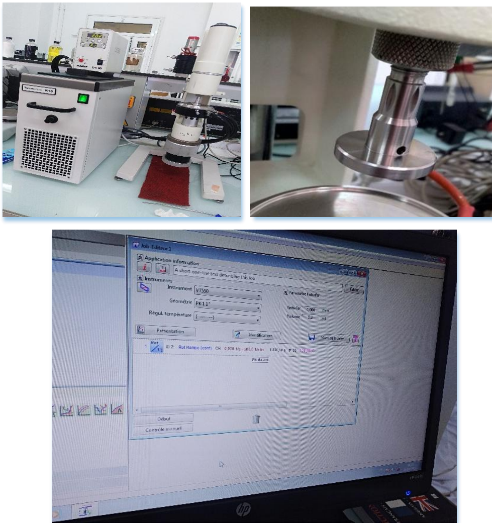
Figure 18: Présentation du matériel utilisé dans l'expérience : (a) Le rhéomètre plus un thermomètre, (b) Le géomètre cône-plan (VT550), (c) Le logiciel utilisé pour les calculs.
