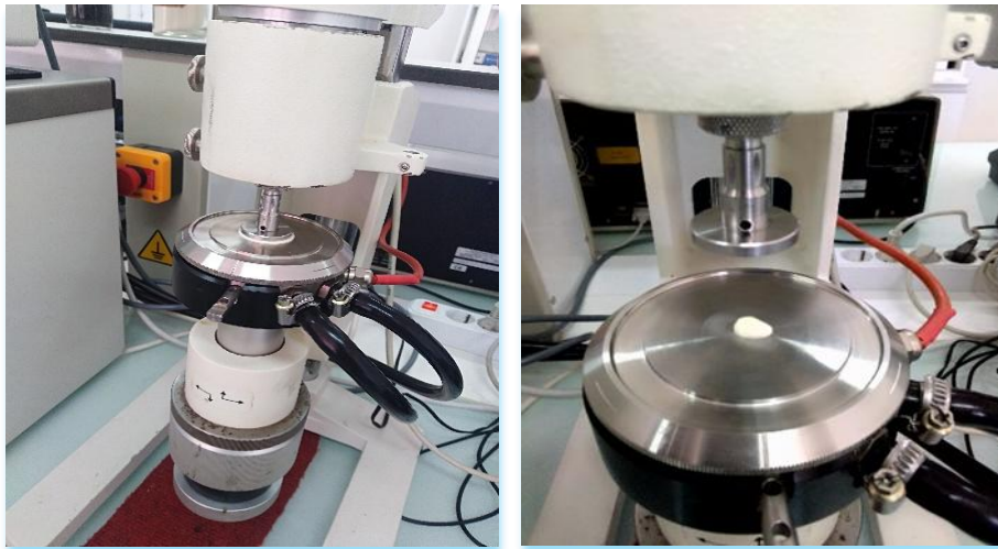
Figure 19: Fonctionnement de Rhéomètre (VT550) et mesure de la viscosité de l'échantillon.
