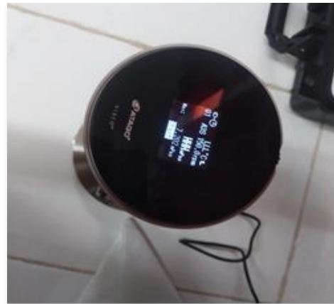
Figure 23: Mesure de la viscosité de chocolat commerciale, et l'erreur mentionnée par l'afficheur.
