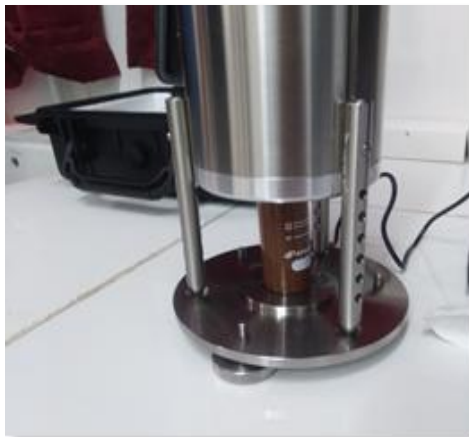
Figure 23: Mesure de la viscosité de chocolat commerciale, et l'erreur mentionnée par l'afficheur.
