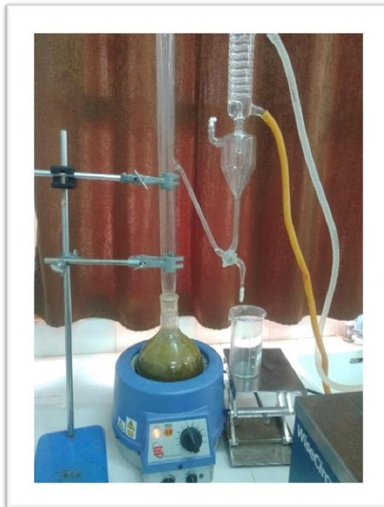
**Figure 14 : décantation (originale) Figure 15 :Montage d'hydrodistillation**
