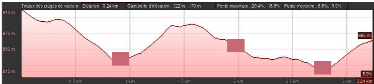
Figure IV. 6 L'emplacement les chambre du brise du charge
