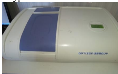
Figure23 : Spectromètre de type OPTIZEN 3220 UV
