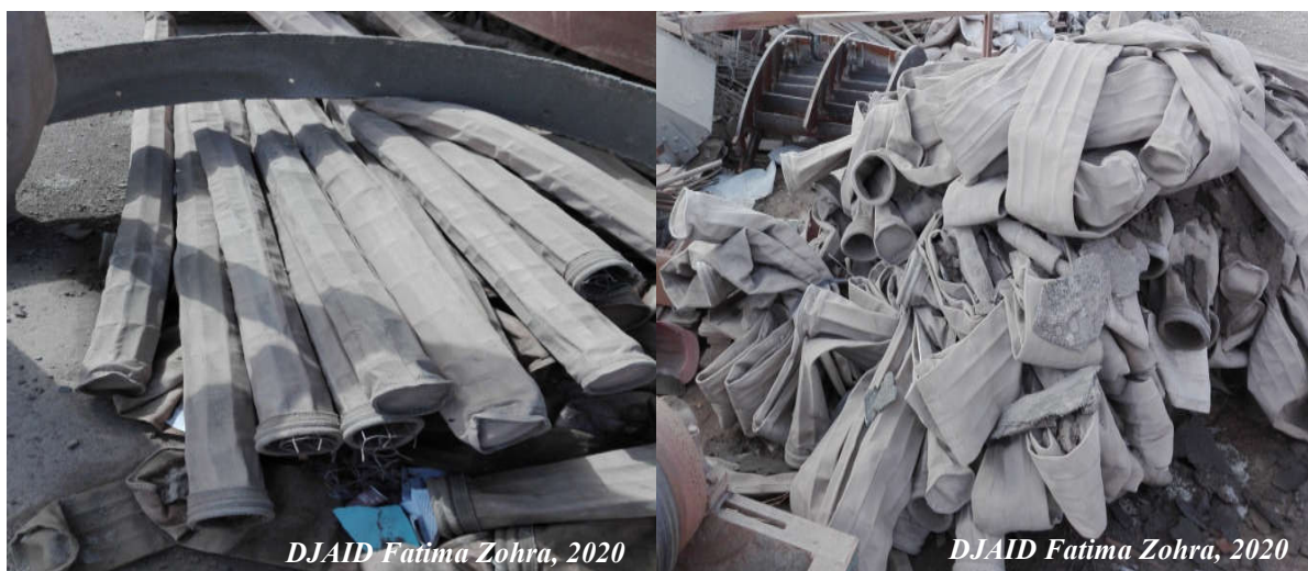
Photo 12: Manche filtrante stocké dans la déchetterie de la cimenterie avant l'élimination.
