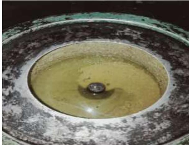
**Figure 25:** Centrifugeuse de l'oléodoseur (Originale, 2022)
