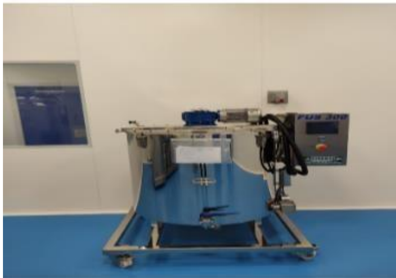
Figure III.3. Cuve de préparation de 500 kg de marque BIONAZ.
