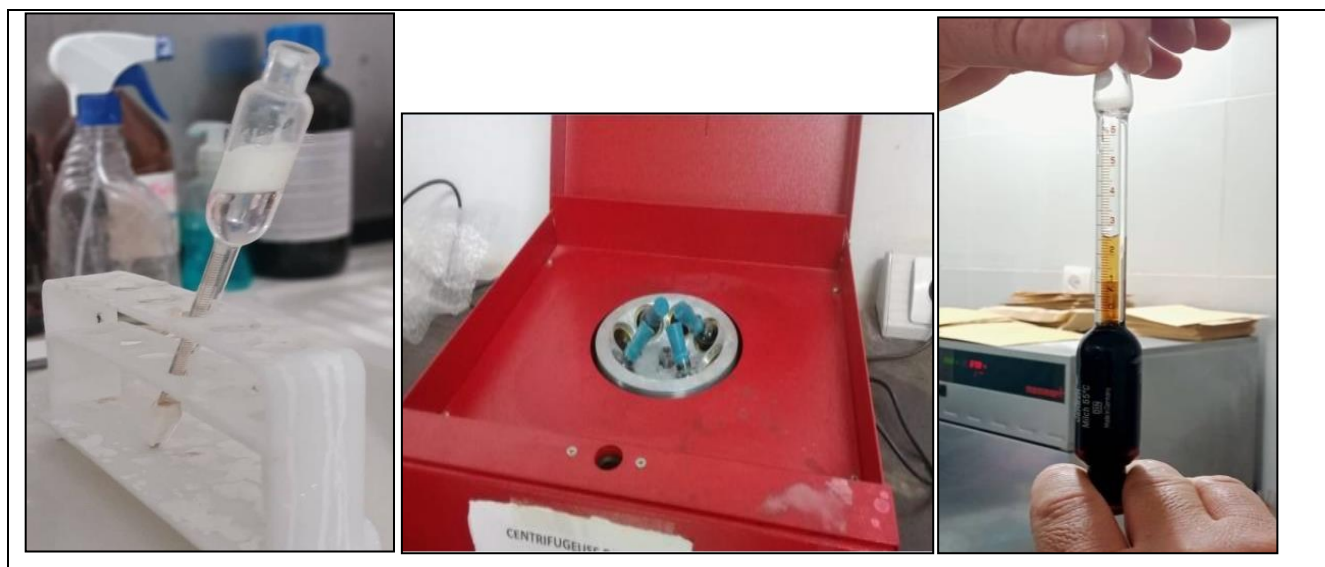
Figure III- 10: Protocole de la détermination du taux de la matière grasse par la méthode de Gerber.
