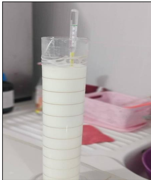
Figure III- 8: Mesure de la densité par thermo lactodensimètre.
