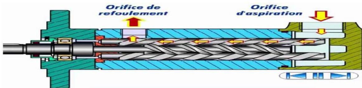
Figure I. 7: Pompes à vis. [3]
