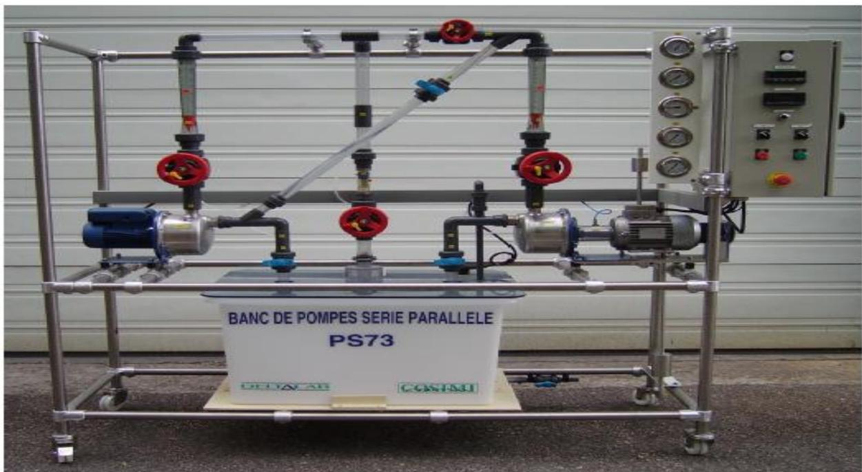
Figure III. 1: Banc de pompe en série parallèle PS73.
