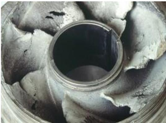
Figure II. 10: Roue soumise à cavitation.
