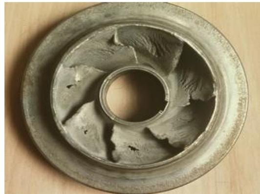
Figure II. 11: Effet de la cavitation sur la roue d'une pompe centrifuge.
