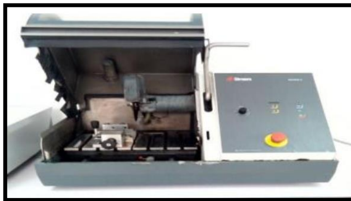
Figure IV-5 : Tronçonneuse utilisée pour découpage
