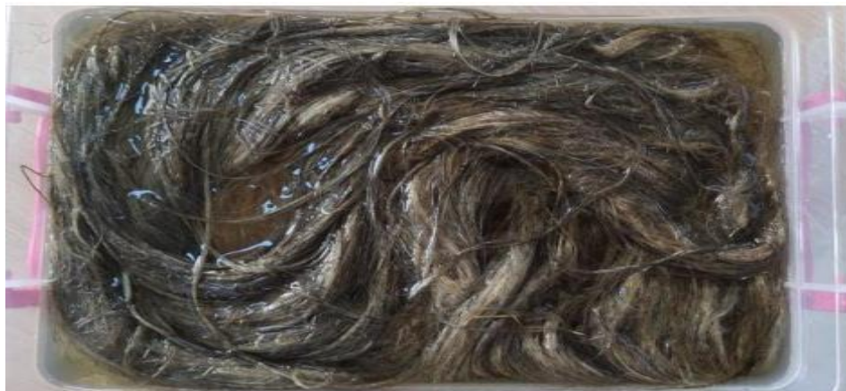
Figure II. 6: Traitement des fibres dans le NaOH (0.5% ,1%)
