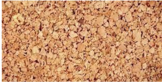
Figure II. 5: Lièges agglomérés de moyenne densité, granulé 3 à 5 mm
