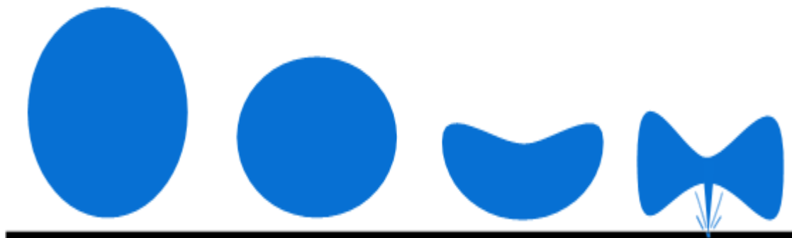
Figure 9 : Schéma de l'évolution d'une bulle de cavitation près d'une surface solide (Pétrier et al., 2008).
