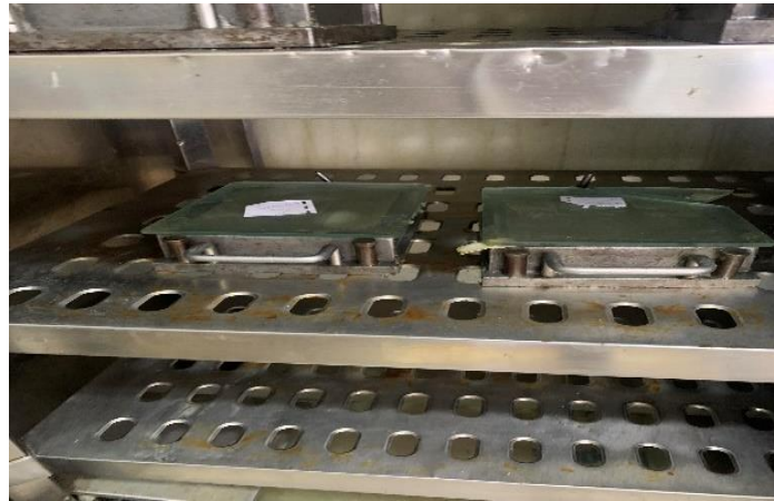
FIGURE II.8 : CONSERVATION DU MORTIER.
