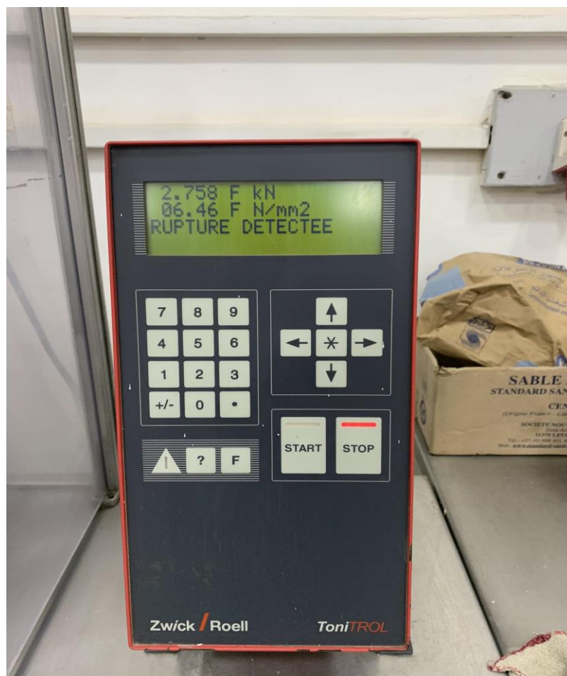
FIGURE II.9 : APPAREIL DE MESURE DE LA RESISTANCE MECANIQUE DU MORTIER.
