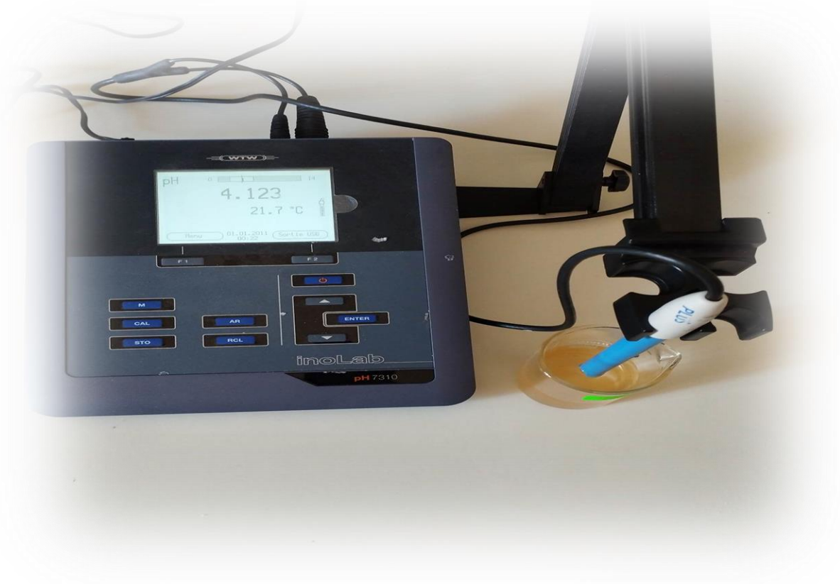
Figure II-3 : Image d'un pH mètre de type InoLab pH 7310.
