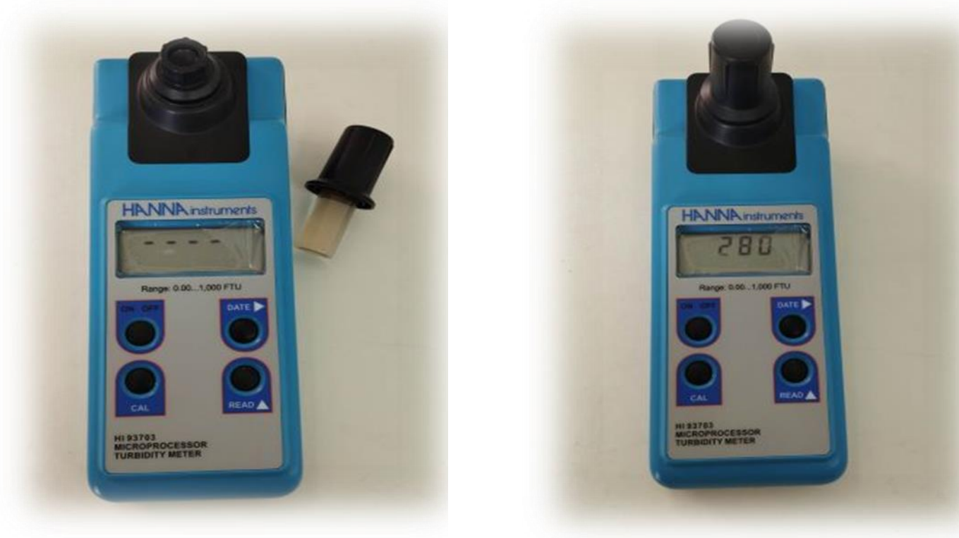
Figure II-5 : Image d'un turbidimètre de type HANNA, HI93703.
