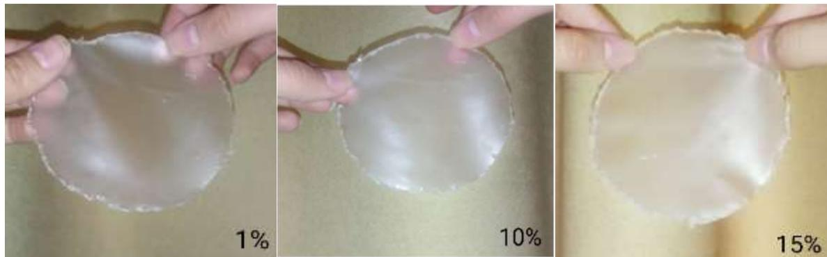
**Figure II.5:** Les films plastifiés d'amidon à différents taux de caséine en présence d'une solution alcaline de NaOH.
