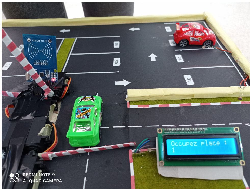
Figure 3.22 : Ouverture de barrière 2 en cas passage de tag RFID.
