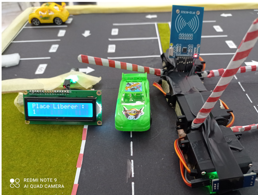
Figure 3.25 : Ouverture de barrière 4 et affichage de sortie.
