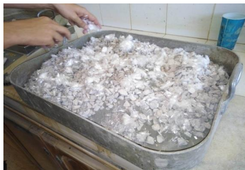
Figure III. 18 : Le mélange d'un béton de fibres polypropylène.
