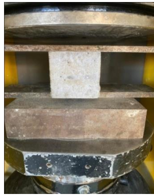
Figure III. 23 : L'éprouvette dans la machine de compression.
