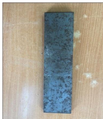
Figure III. 22 : La plaque métallique de dimension 7*7*28 cm 3 .
