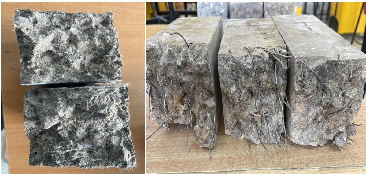
Figure. 7 : la forme d'éprouvette après l'essai de flexion (béton de fibres polypropylène et métallique avec une teneur de fibres 1.5%)
