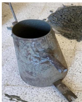
Figure III. 19 : Essai d'affaissement avec le cône d'Abrams.
