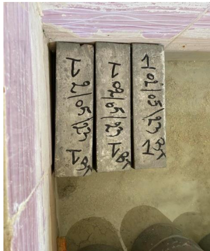
Figure. 9 : la conservation des éprouvettes dans l'eau ( 20°C)
