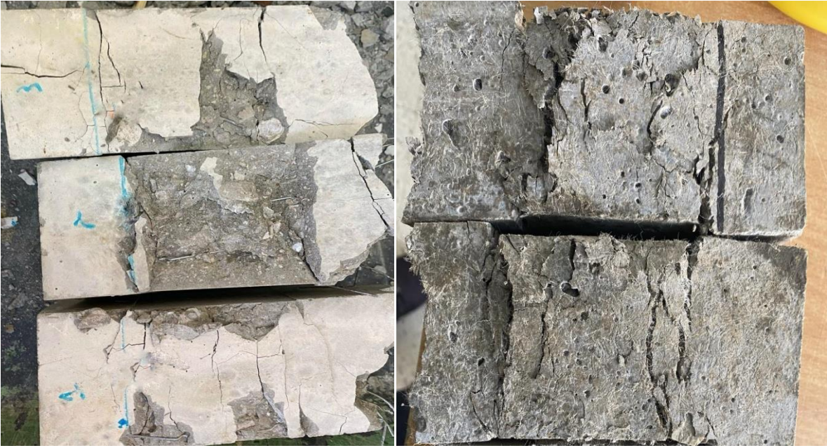
Figure. 8 : la forme d'éprouvette après l'essai de compression (béton de fibres polypropylène et métallique avec une teneur de fibres 1.5%)
