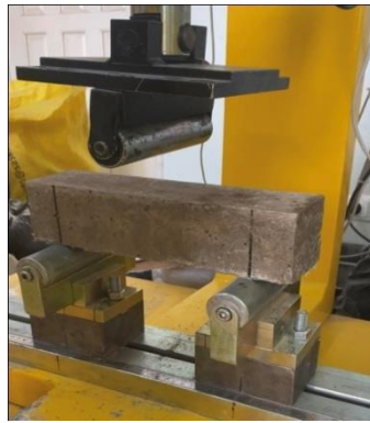
Figure III. 21 : La machine de flexion avec l'emplacement d'éprouvette
