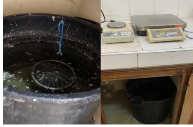
Figure. 4 : essai de la masse volumique absolue des fibres métallique
