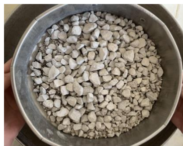
Figure III. 7 : Essai de propreté superficielle sur le gravier 8/15.
