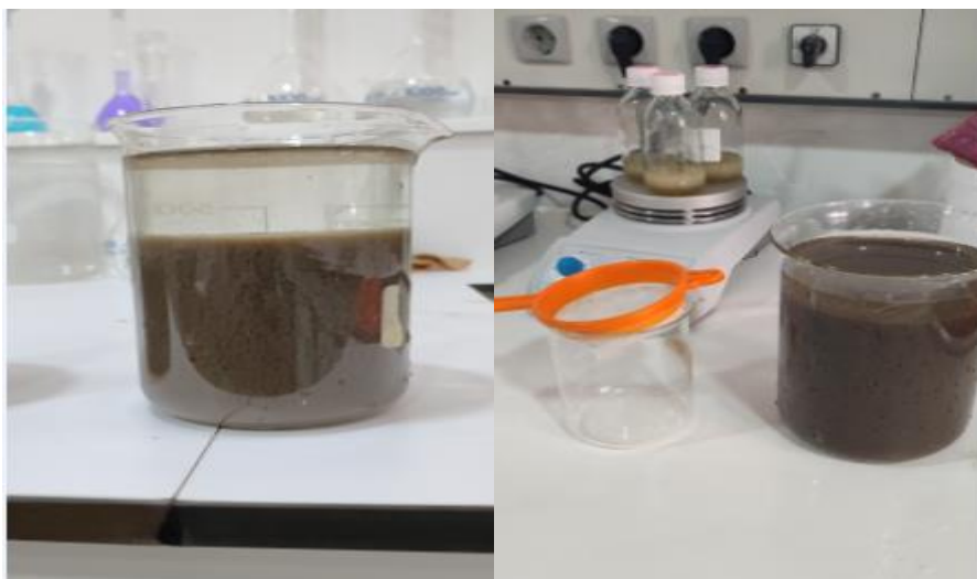
Figure II. 1 : Lavage des boues activées
