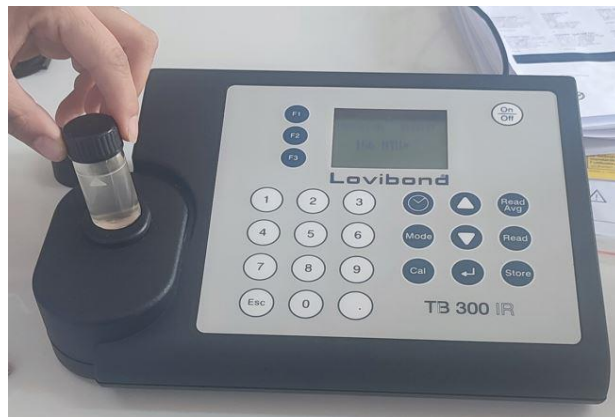
Figure II. 17 : Turbidimètre de marque Lovibond TB 300 IR
