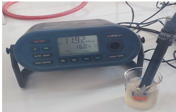
Figure II. 16 : Conductimètre de marque Cond 1970i
