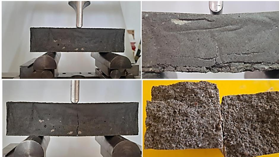
Figure III. 19 : Essai flexion trois points.
