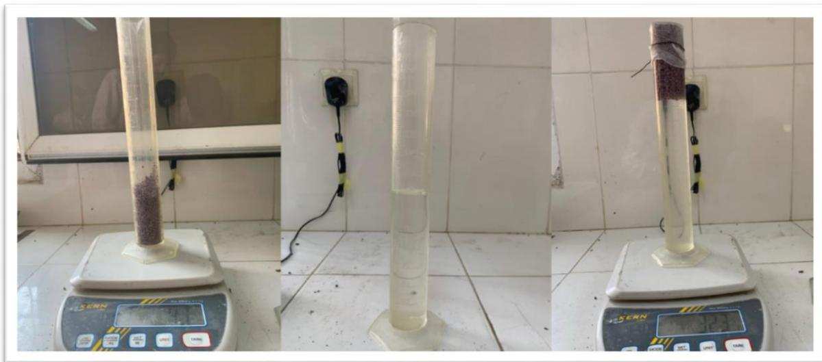
**Figure III. 13 :** Essais de la masse volumique absolue du plastique.
