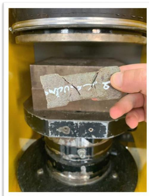
Figure III. 18 : résultat d'essai de compression.
