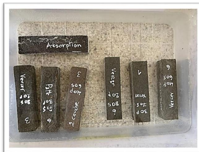
**Figure III. 29 :** Essais d'absorption.
