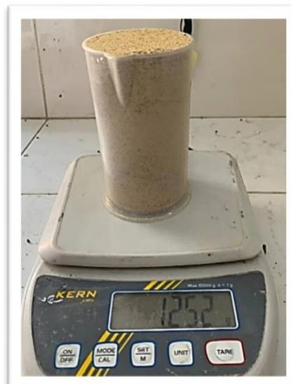
Figure III. 2 : Essais de la masse volumique apparente du sable.
