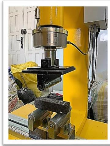
**Figure III. 15** : Essai de flexion trois points.
