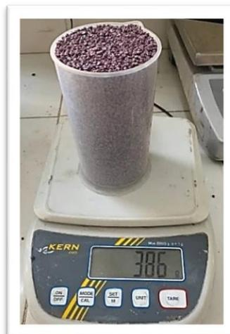
Figure III. 12 : Essais de la masse volumique apparente du plastique.
