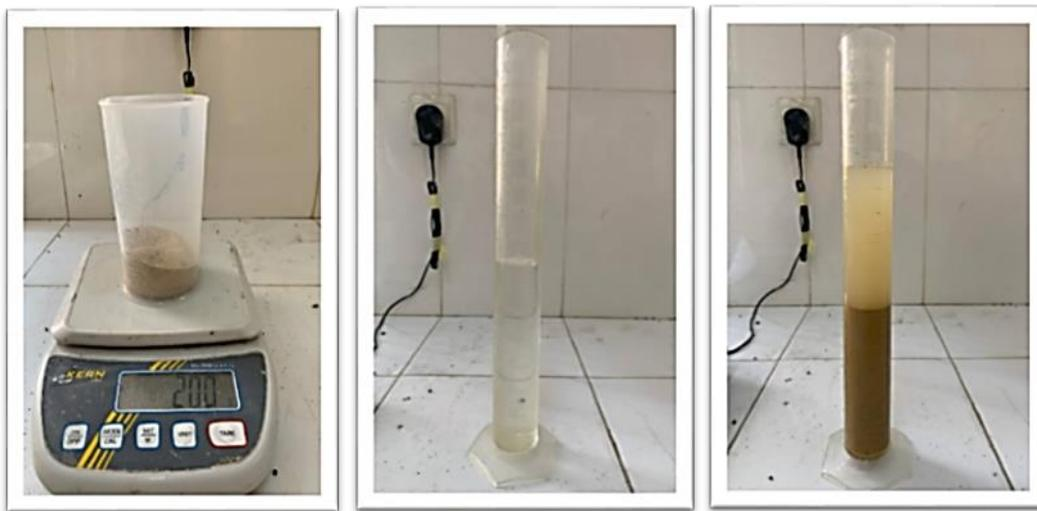
Figure III. 3 : Essais de la masse volumique absolue du sable.
