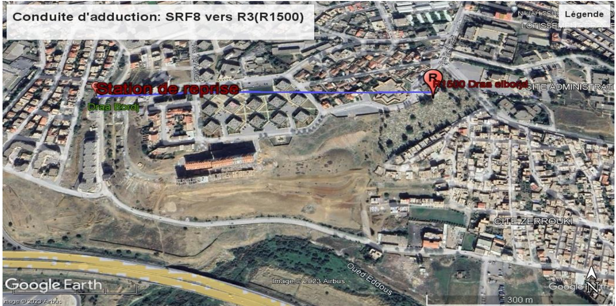
Figure V.41: Conduite d'adduction SRF8 vers R 1500
