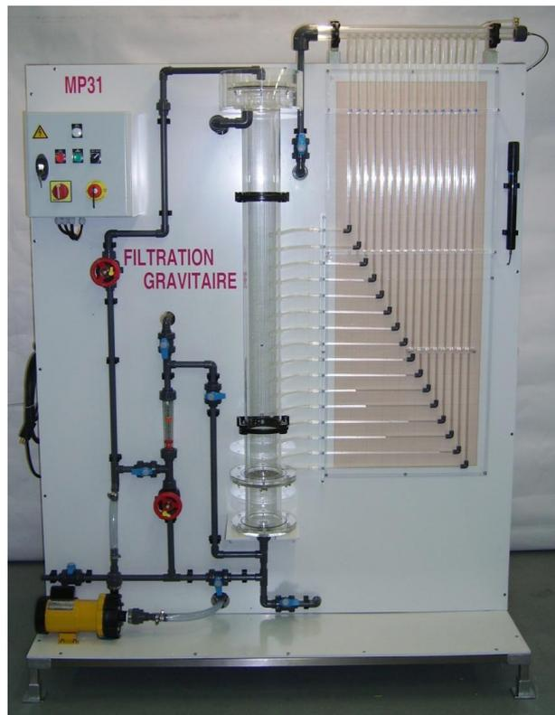
Figure 2.1 : Pilote MP31 de la filtration gravitaire.
