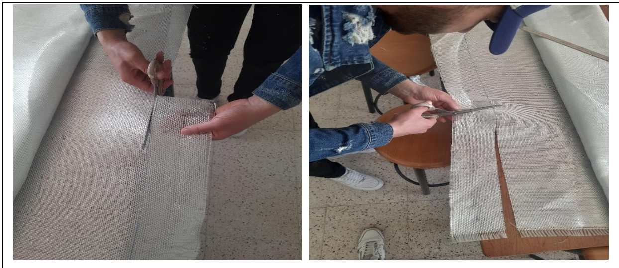
Figure III.6. Préparation de tissu de fibre de verre
