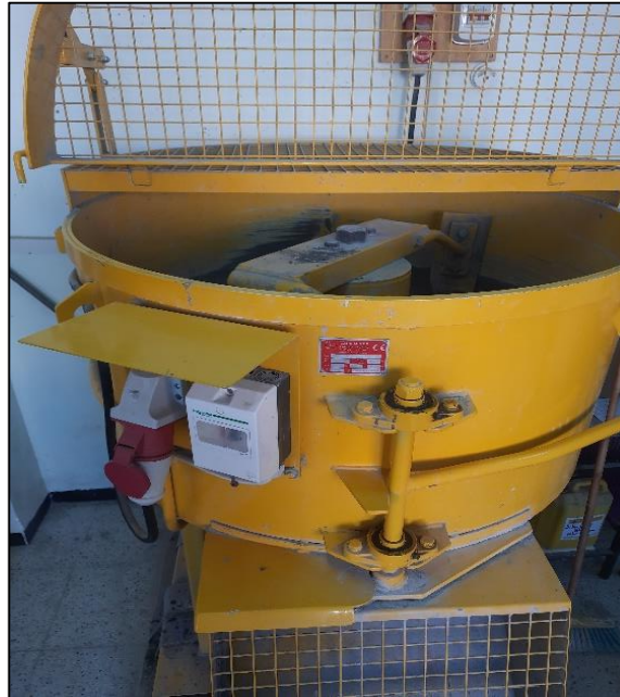
Figure III.9. Malaxeur à axe vertical de capacité 50L
