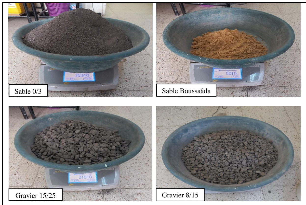
Figure III.1. Les granulats utilisés dans la formulation du béton
