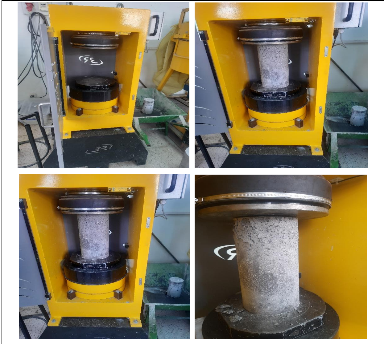
Figure III.8. Essai de compression à 28 jours
