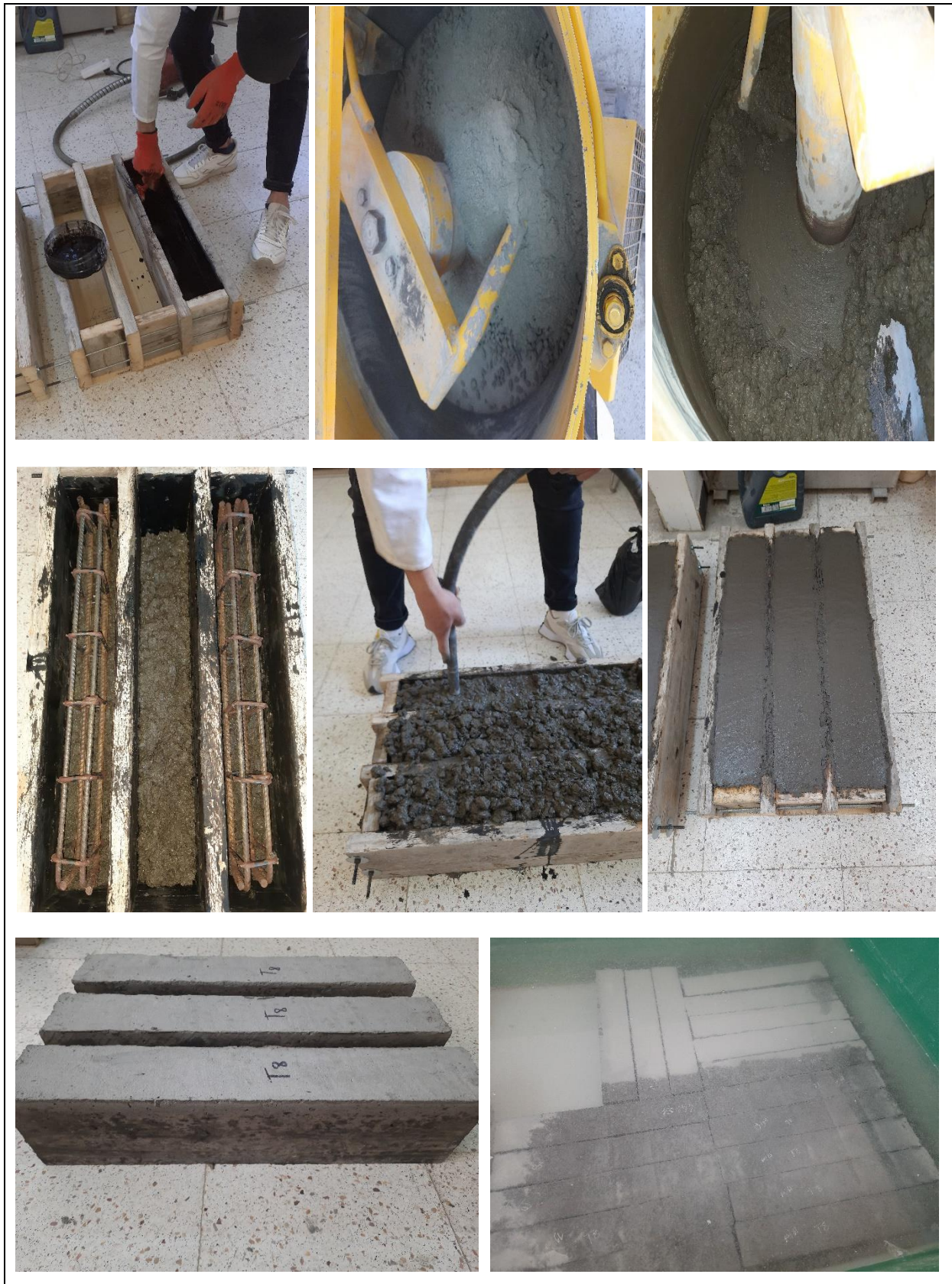
Figure III.10. Préparation des poutres testées
