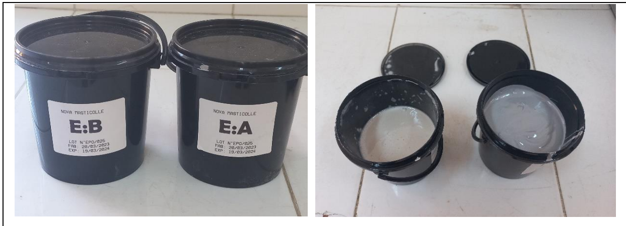
Figure III.3. Résine (élément A) et durcisseur (élément B)
