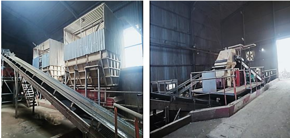
Figure I-14 : Dosage et broyage d'argile
