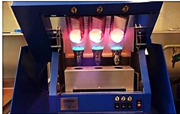
Figure II-9 : Coulage de la pastille à 900°C
