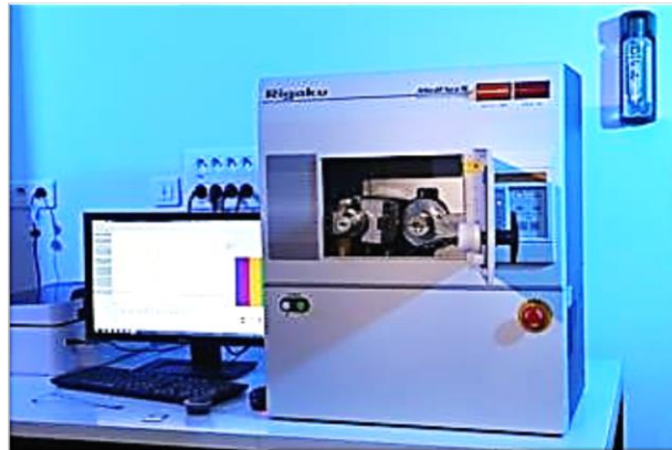
Figure II-11 : Image d'un DRX (Diffractomètre a Rayon X)
