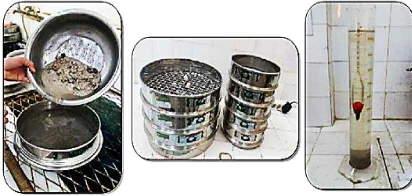
Figure II-2 : Analyse granulométrique par tamisage à sec après lavage
