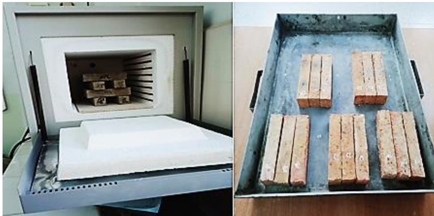
Figure III-3 : les éprouvettes avant et après la cuisson
