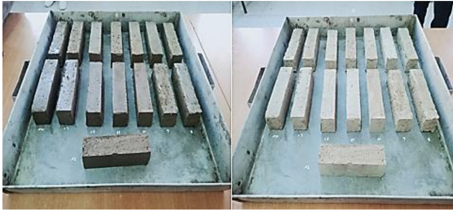
Figure III-2 : les éprouvettes moulées sur la gauche à séchage libre et sur la droite après séchage à l'étuve
