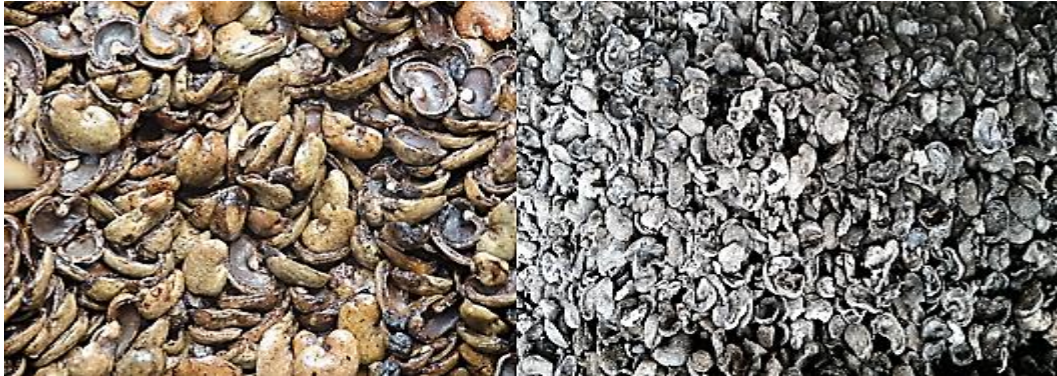
Figure I-27 : coques de noix de cajou à droite et à gauche le charbon de coques de noix de cajou
