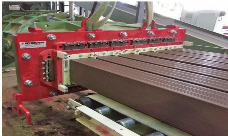
Figure 0I-16 : Le façonnage de la brique en terre cuite
