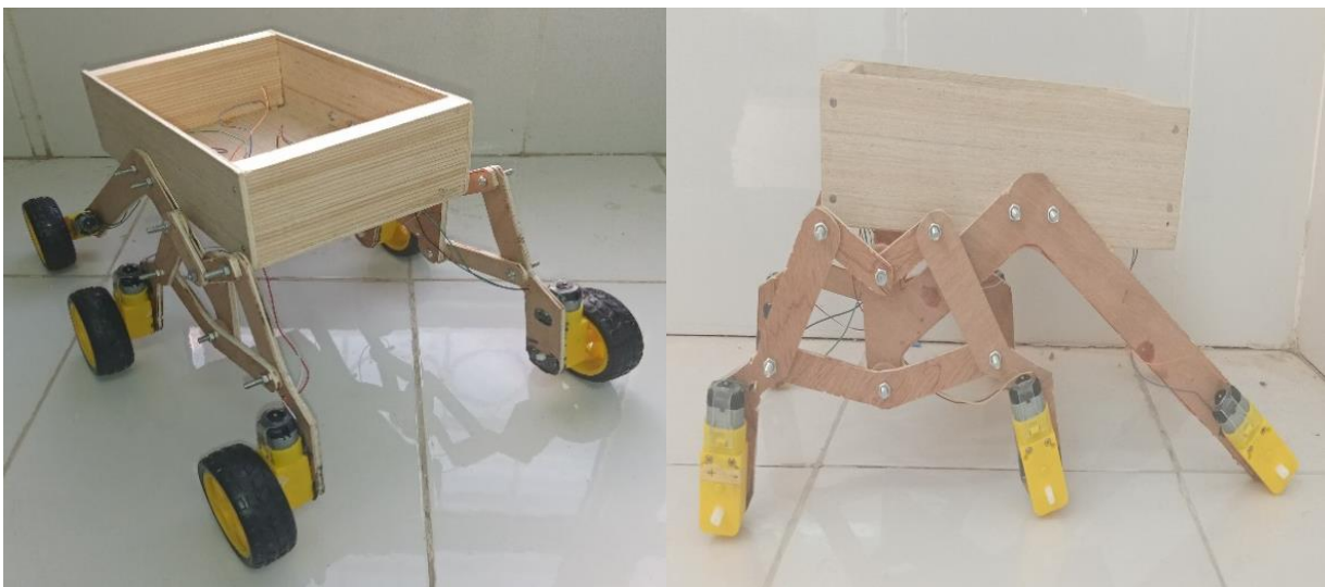
Figure 3. 3. Assemblage final du corps du robot et mise en place des moteurs de roue.
