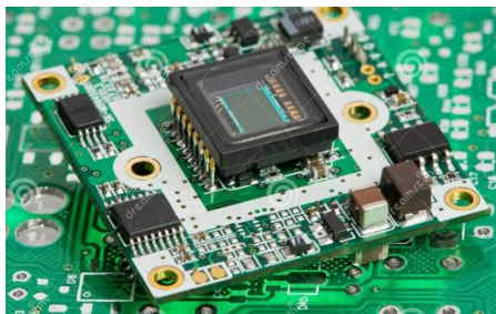
Figure 2. 22. La puce du capteur d'image [21].
