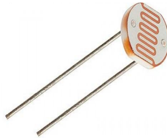
Figure IV.10 : La photorésistance LDR [53]
