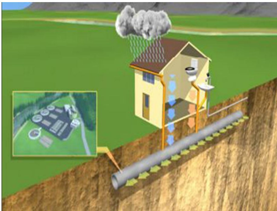
Fig IV.2: Schéma d'un réseau unitaire (CHIKAOUI ; 2008)
