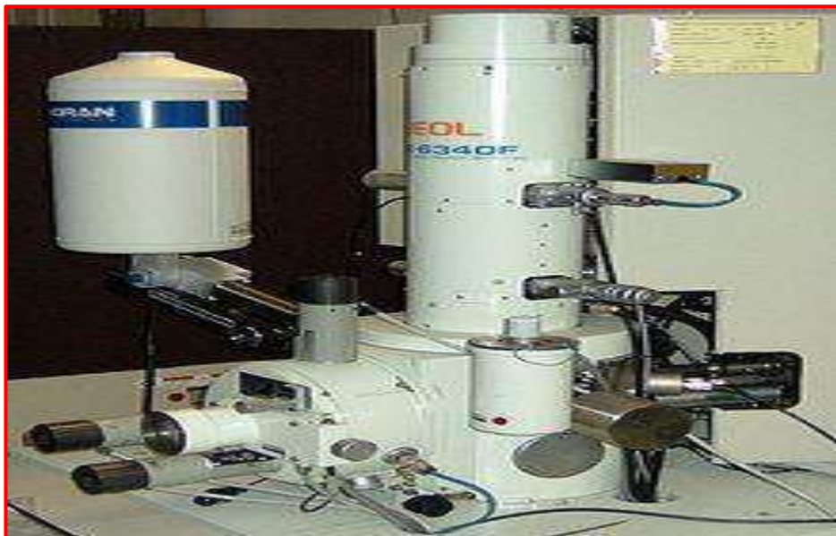
Figure II.4 : Microscope électronique à balayage JEOL JSM-6340F [15]
