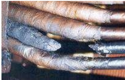
Figure 1. 17: Coupure suite à la fusion d'un Conducteur [7].
