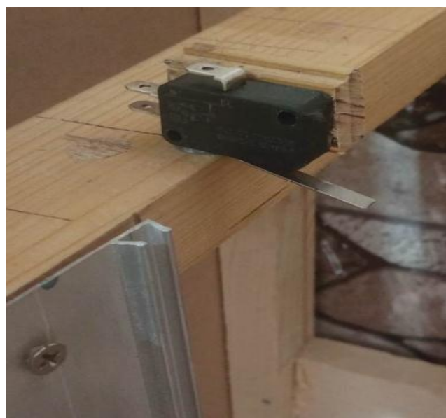
Figure III.32 : Capteur de position de E1
