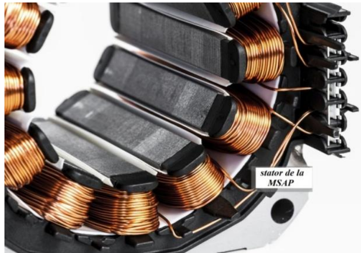
Figure I. 2. Vue de coté du stator de la MSAP.
