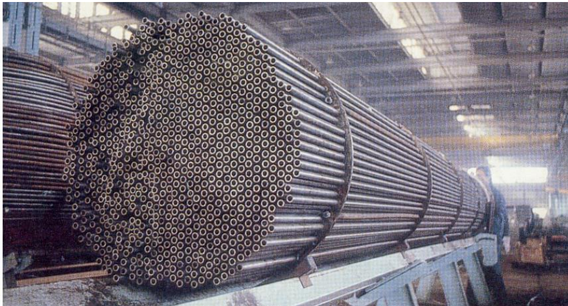
Figure I.9: Le faisceau tubulaire.
