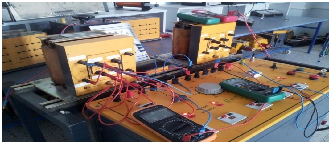
Figure III.3. Montage de l'essai en court-circuit d'un transformateur monophasé.
