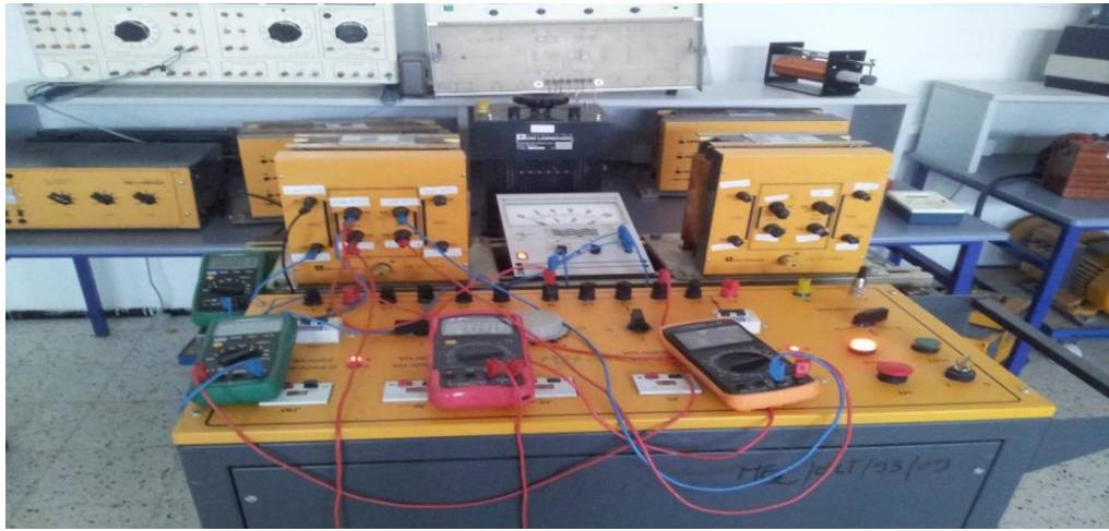
Figure III.2. Montage de l'essai à vide du transformateur monophasé.
