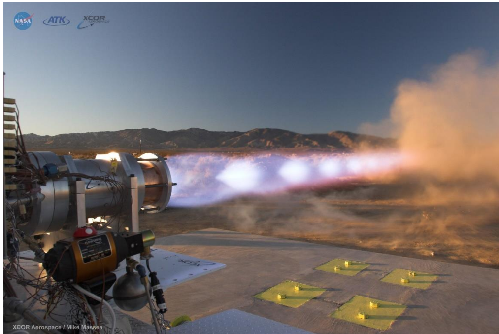
Figure I.1 : Moteur-fusée à méthane testé avec succès [35]
