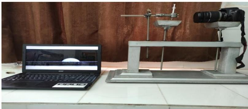
**Figure 2.3 :** Dispositif de mesure de l'angle de contact.
