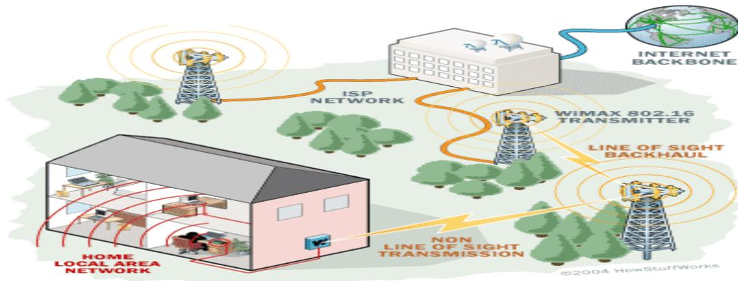
Figure 1.7 : Le principe de fonctionnement du WiMAX [13]
