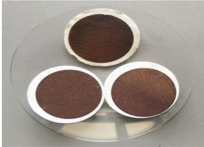
Figure II.2. Les paraffines déposées sur les papiers filtres.
