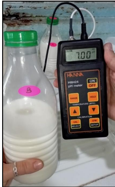
Figure 12: Mesure de pH à l'aide d'un pH-mètre (Photo originale).
