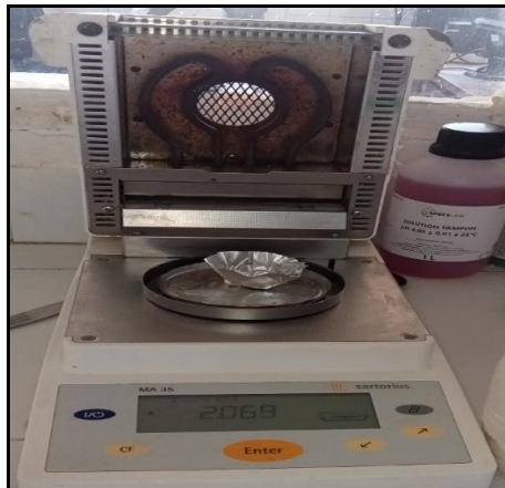
Figure 15 : Mesure de l'extrait sec à l'aide d'un dessiccateur (Photo originale).
