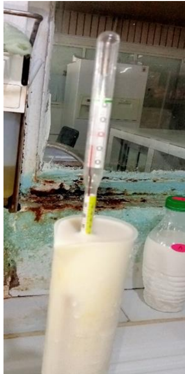
Figure 14: Mesure de la densité à l'aide d'un thermo-lacto-densimètre (Photo originale).
